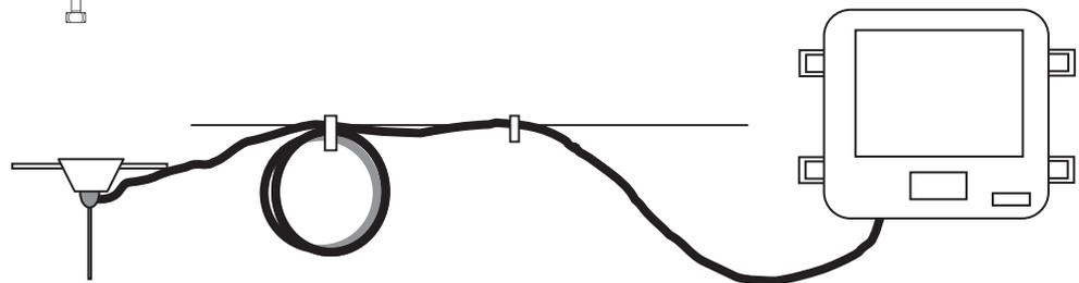
アンテナケーブルは無理に曲げないでください。ゆるいアールを付けて配線し、余ったケーブルは、大きめの輪にして固定します。アンテナケーブルは、他の電線と束ねないでください。
