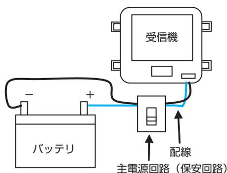
バッテリー交換の際、必ず無線システムの電源を切って作業をするようにしてください。
