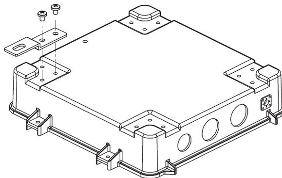
②ボルト等で固定します。(4ヶ所、M8、締付トルク 11.5N・m)
