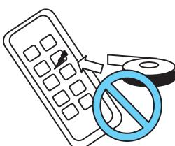
送信機の破損、ひび割れ等がある場合は使用しないでください。応急処置としてテープなどで補強して、使用しないでください。内部に水や異物が浸入して異常動作や故障の原因になり危険です。
