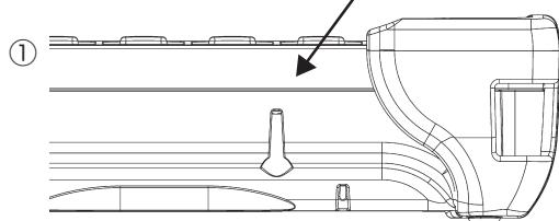
①マジックテープ裏にある接着テープを剥がし、送信機の側面に貼り付けてください。
