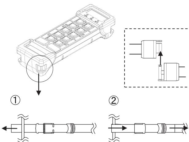
添付のストラップを図のように送信機のベルトシャフトに通し、固定して使用します。4ヶ所のベルトシャフトの何れにも取付け可能ですので、様々な保持姿勢が選べます
