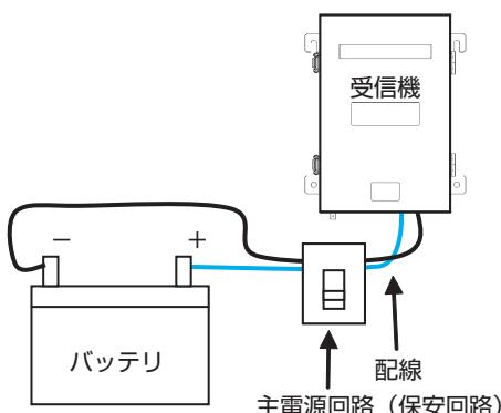
バッテリ交換の際、必ず無線システムの電源を切って作業をするようにしてください。
