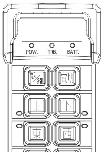
1. 安全を確認し、クレーンの主電源および受信機の電源を入れます。
