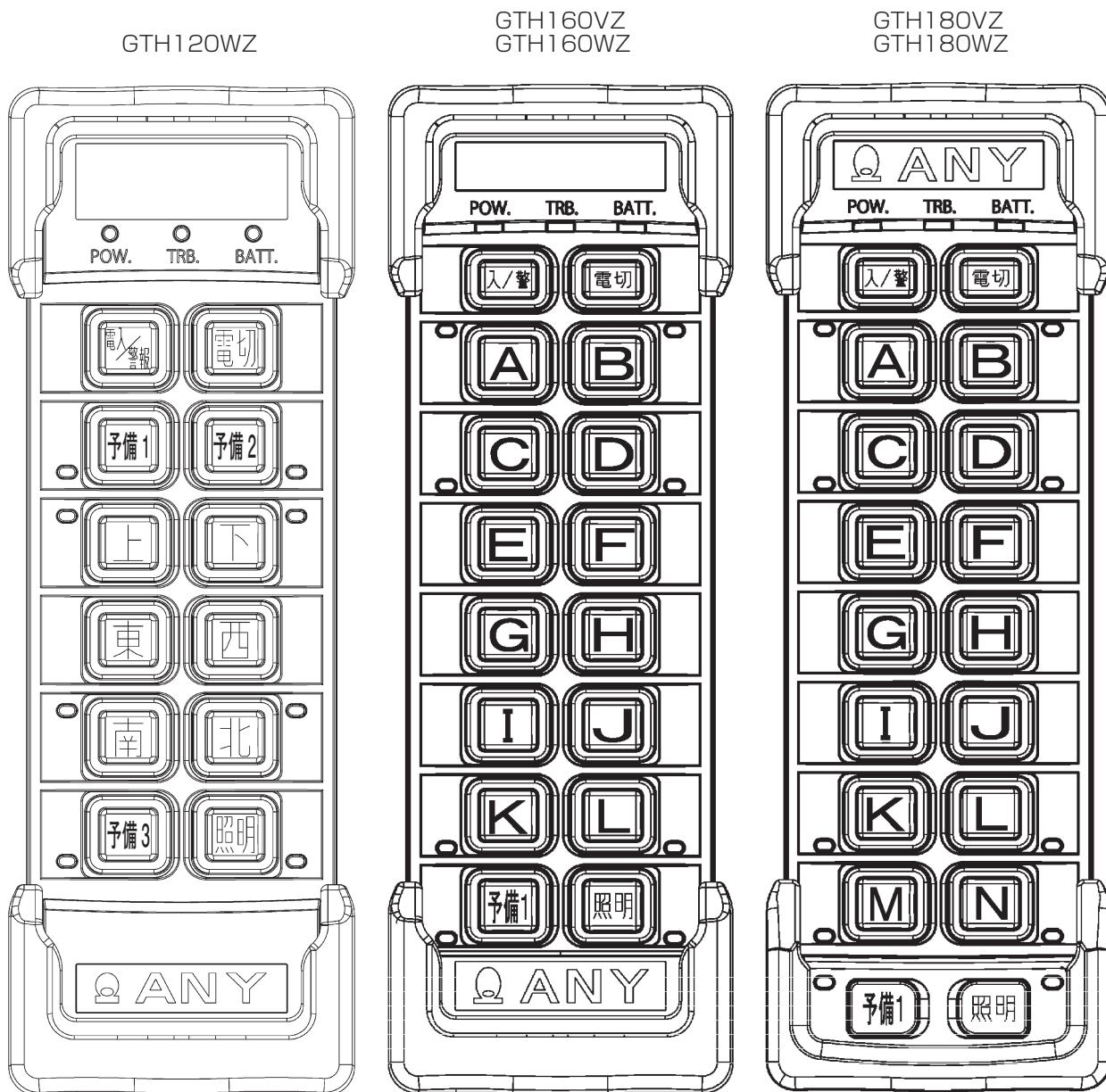
※スイッチ 予備 1,2,3 および A～N は、出力端子図に対応しています。実際の操作名称に読み替えてください。
