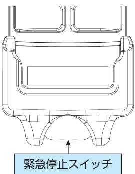
操作中に緊急停止スイッチを押すと送信機の電源を切る機能です。再度、操作する際は、緊急停止スイッチを解除しないと送信機の電源は入りません。
