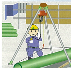
巻き上げ機の操作
